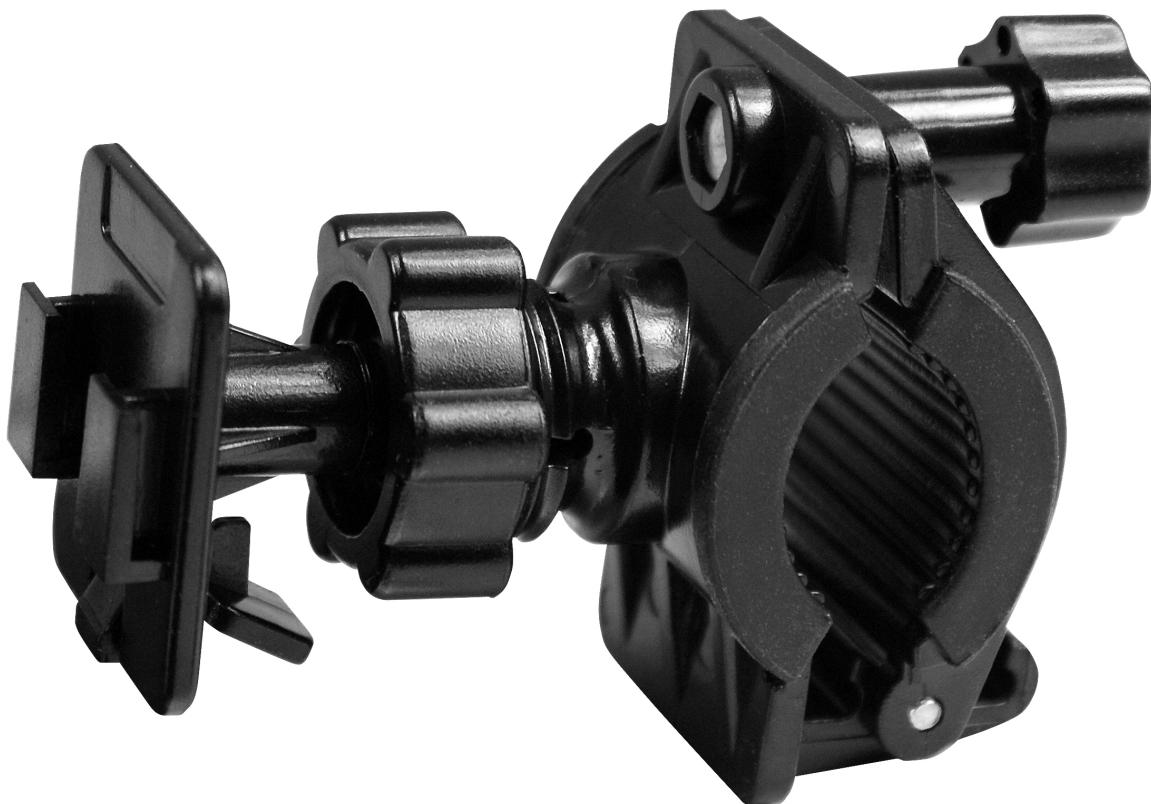
Diese Universelle Fahrradbefestigung wird an die Lenkstange des Fahrrads befestigt. Die Montage erfordert kein Werkzeug und kann schnell und sicher befestigt werden. Zwei T-Sockel versprechen besten Halt auch bei hoher Beanspruchung. Durch den Kugelkopf ist die Position der Halterung stufenlos wähl- und um 360° drehbar.
